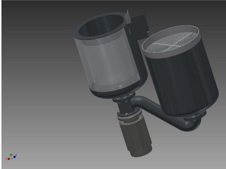
Abbildung 42: Möglicher 3D-Versuchsaufbau ChemGran Reaktor [Dörler]
