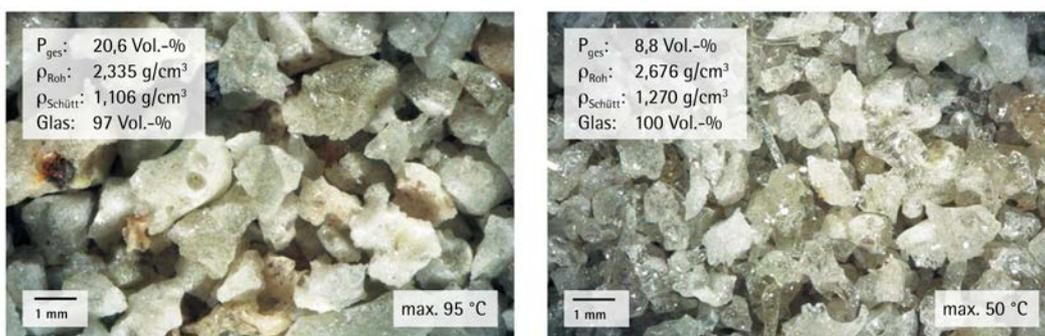
Abbildung 18: Wirkung verschiedener Granulationswassertemperaturen auf die Hüttensandeigenschaften bei gleicher chemischer Zusammensetzung [2]
