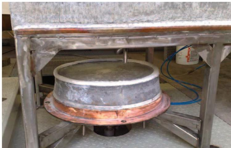
**figure 8: InduCarb bottom discharge unit**
